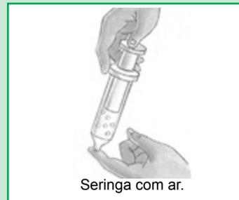
Deixe o êmbolo da seringa em determinada posição e tampe o bico com o dedo, para o ar não escapar, conforme a figura.
